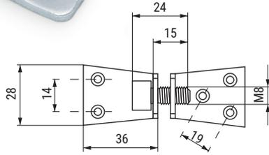
• Esta compuesto de dos placas + un tornillo allen DIN 912 M8x15mm.
