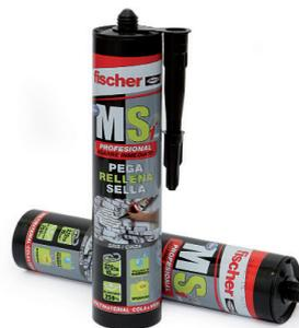
Adhesivo y sellante elástico monocomponente de rápida curación basado en MS polímero, con elevada adherencia inicial (basada en su alta viscosidad). Retícula con la humedad, curado neutro, libre de olores, de disolventes, de siliconas y de isocianatos.
