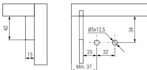
Mecanizado para tornillos tirafondo Ø5X16
