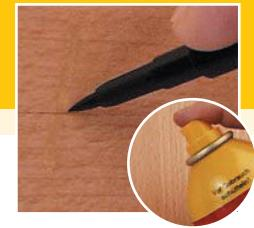
**Vorbereiten:** Alle losen Teile entfernen. Bei Echtholzoberflächen Schadensränder rund drücken. Bei künstlichen Oberflächen (wie z.B. Melamin, PVC, usw.) Schadensränder gerade nach unten mit dem Kantenegaliseer abstechen.
