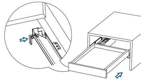
Presionar pasador de bloqueo de la guía, para fijar el cajón.
