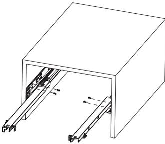
Fijar las guías en el lateral del mueble
