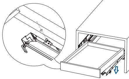
Extraer las guías y colocar el cajón encima, alineando el pivote de la guía con el mecanizado del cajón.
