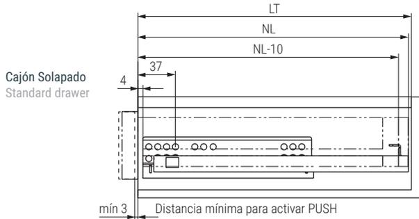
NL= longitud de deslizamiento nominal LT= profundidad interna del mueble LT = NL+21
