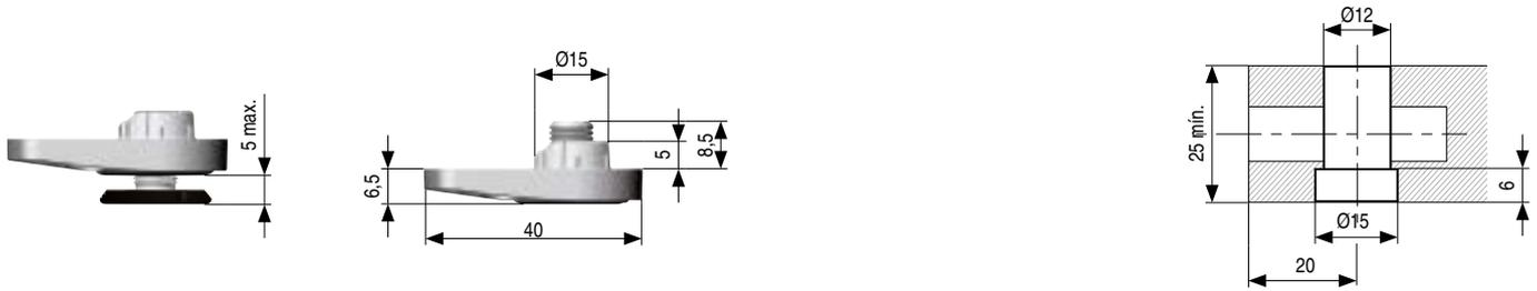
• Para el montaje con el pie nivelador de 0 a 5mm., podemos usar el tornillo rosca madera Ø3,5x15., cód.: 9011.94. Para otras medidas, ver en grupo 4.
