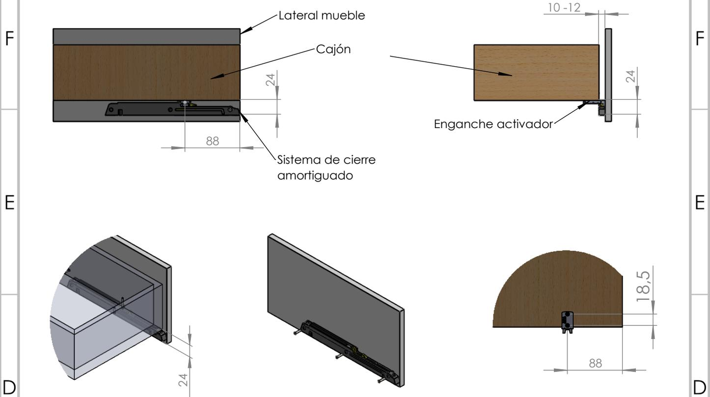
Paso 1: Colocar la base del freno a 24 mm de la base del cajón y enrasar al frente del mueble.
