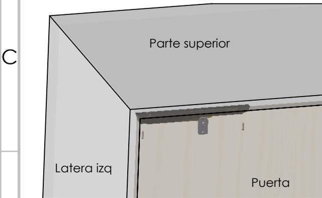
Paso 1: Colocar la base del freno en la parte interna superior del mueble, enrasado al borde y a una profundidad de H. Posteriormente atornillar los dos tornillos de fijación.
