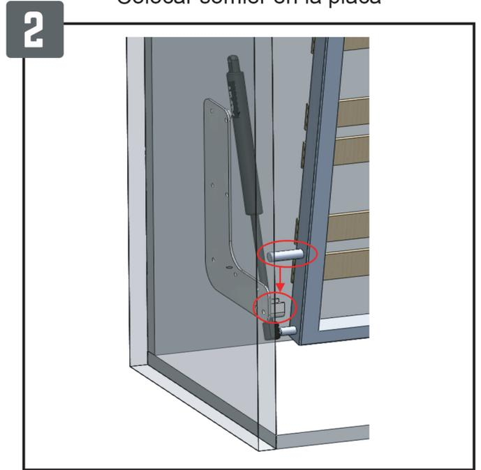
Sujeción del elevador a gas a la placa lateral del armario
