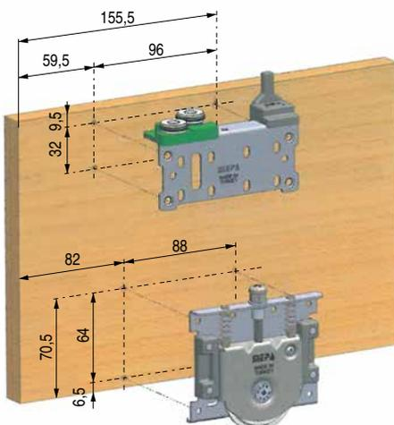
MECANIZACIÓN: Esquema de montaje de las ruedas superiores e inferiores ajustadas para el funcionamiento de los cierres amortiguados.
