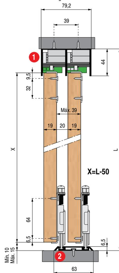
Ejemplo de adaptación del kit RONCADE en puertas de madera. montado con las guías superior e inferior VIALE RONCADE (1,2).
