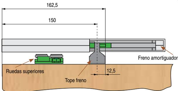
Descripción de las medidas para colocar el freno amortiguado y el tope de freno.
