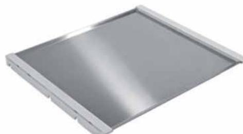
La bandeja de acero inox. AISI 430 presenta una buena resistencia a la corrosión en ambientes medianamente agresivos, (como es el caso del mueble donde se colocan los productos de limpieza agresivos) y es resistente a la oxidación. Se coloca a los costados del mueble por medio de los soportes de plástico ABS. Posibilidad de utilizar también como estante para colocar accesorios de limpieza y otras utilidades
