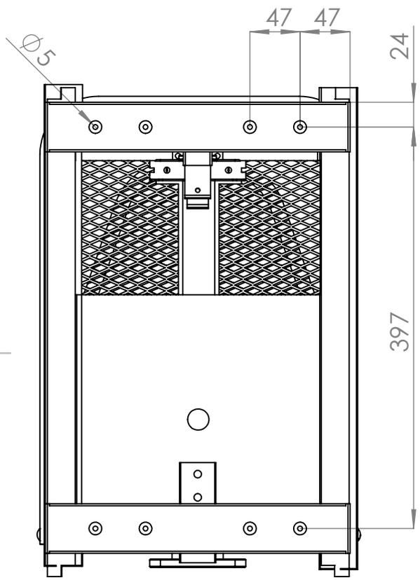
MEDIDAS MINIMAS PARA INSTALARLO DENTRO DE UN CAJA
