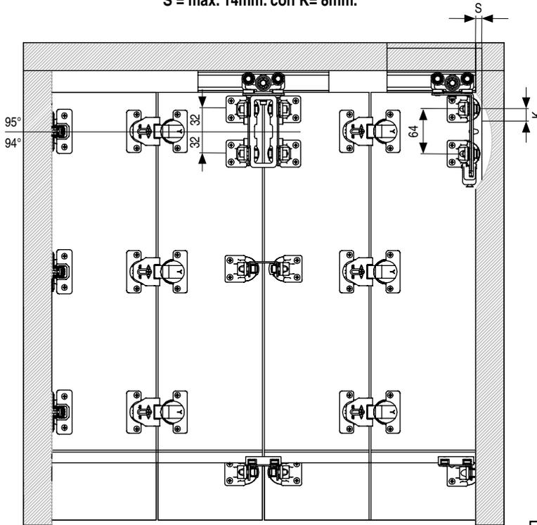
Ejemplo de mecanización de la bisagra a la puerta, eje centrado
