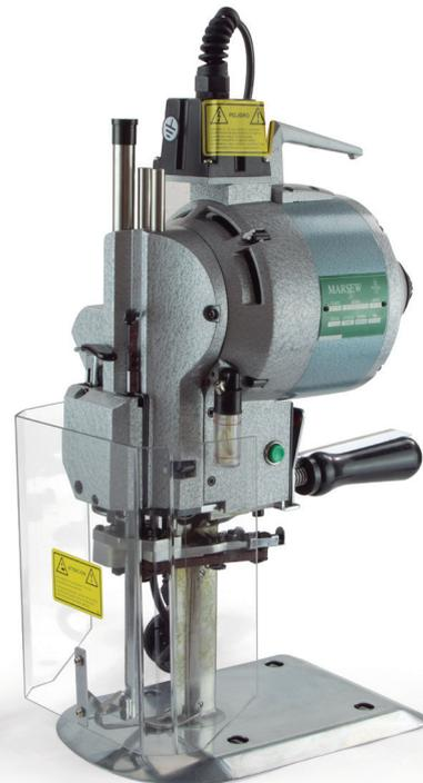
Máquina de corte vertical, con una altura útil de 11cm., equipada con sistema de protección según las normativas de la CE. Palanca en el puño para desconexión del motor y bajada del prensatelas automático.
