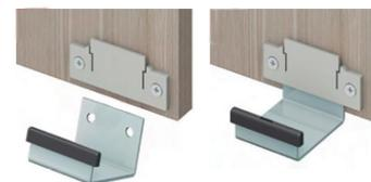
Desenganche del patín inferior. Mover la solapa de plástico con un destornillador y hacer presión del patín hacia abajo.
