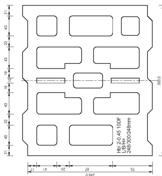
Bloque hueco de hormigón ligero Hbl 2-0,45-10DF de acuerdo con la norma EN 771-3 longitud/anchura/altura = 250 mm/300 mm/248mm
