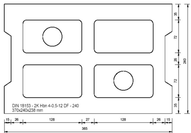
Unidad de mampostería de hormigón Hbn 4-12DF de acuerdo con la norma EN 771-3 longitud/anchura/altura = 370 mm/240 mm/238 mm
