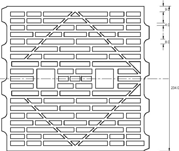
Ladrillo hueco de arcilla HLzW 6-0,7-8DF de acuerdo con la norma EN 771-1 longitud/anchura/altura = 250 mm/240 mm/240 mm
