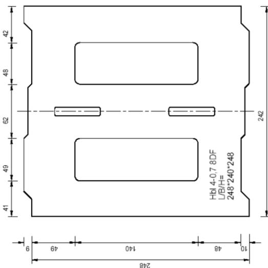
Bloque hueco de hormigón ligero Hbl 4-0,7-8DF de acuerdo con la norma EN 771-3 longitud/anchura/altura = 250 mm/240 mm/248 mm
