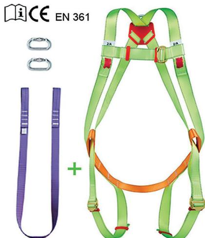
• Anticaídas, regulable en muslos y pecho, ajuste pectoral con hebilla metálica. Doble pasador en resina antideslizante en ajuste de pecho y piernas, incorpora pasadores laterales para acoplar cinturón de posicionamiento, hebillas metálicas de cierre de pestaña para una apertura más rápida. Incorpora bolsa de transporte y cinta de amarre de 1,5 m y 2 mosquetones.
