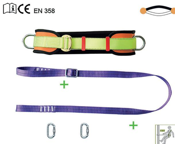
• Cinturón de posicionamiento en altura, acolchado integral, regulable, adaptable a todos los modelos de arnés, doble pasador en resina antideslizante, hebilla metálica de cierre de seguridad con apertura rápida. Incorpora bolsa de transporte y cinta de amarre de 1,5 m y 2 mosquetones.
